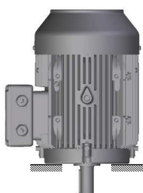
IM V18 IM 3611 tarcza kołnierz, od strony napędowej, bez łap, wałkiem w dół
